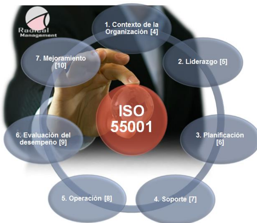
Figura 3. Estructura de los requisitos de ISO 55001 acorde con lo establecido en el anexo SL de la ISO.
