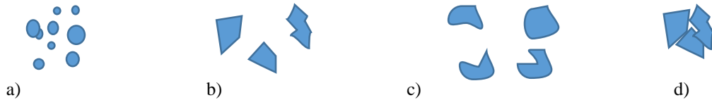
Figura 4. Granos de arena, a) redondos, b) angulares, c) subangulares, d) compuestos.
